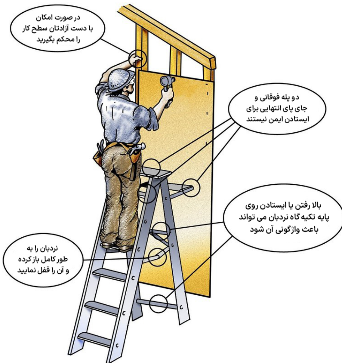
شکل ۸-۵- نکات مهم در استفاده از نردبان های دو طرفه
