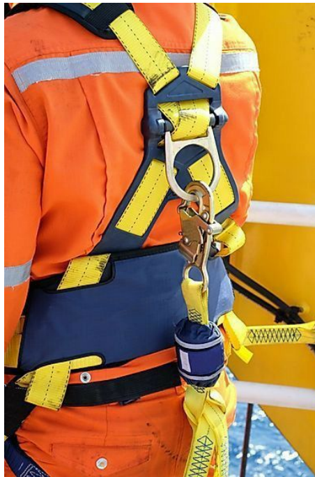
شکل ۱۰-۹- نمونه اتصال قلاب لنیارد با شوک‌گیر به حلقه D هارنس تمام‌تنه
