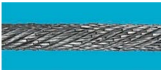
ث- ۲- ولی شکستگی در سیم‌های داخلی وجود دارد
