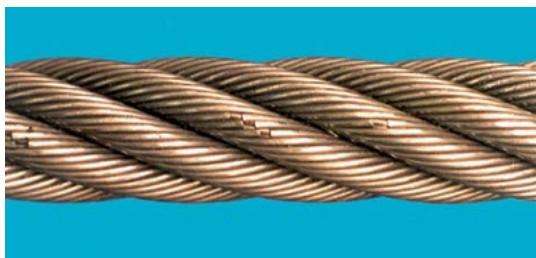
ب- شکست سیم برآمده روی سطح خارجی رشته ۲
