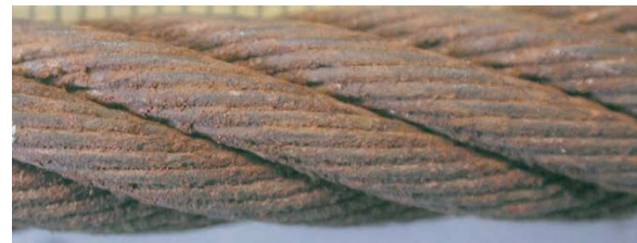
ب- زبری سیم‌ها محسوس است، خوردگی سطح کلی - شدت ۲۰٪ تا مرحله خارج از رده شدن
