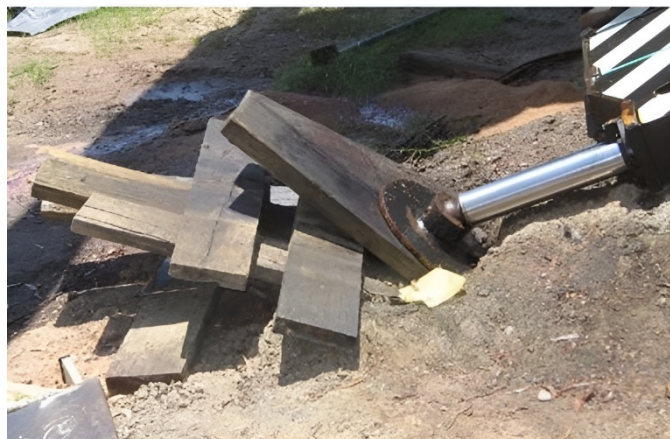
شکل ۱۶-۹- فرو رفتن کفشک جک تعادل در زمین سست
