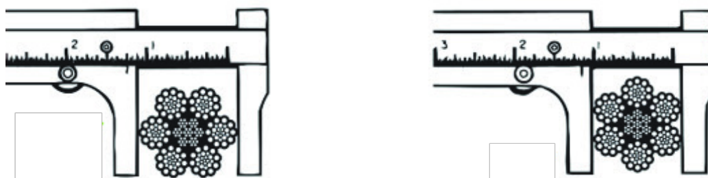
پ- روش صحیح اندازه‌گیری قطر سیم‌بکسل
