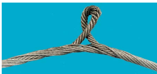
ذ- برآمدگی سیم‌بکسل داخلی در سیم‌بکسل نتاب (مقاوم به چرخش) ۴
