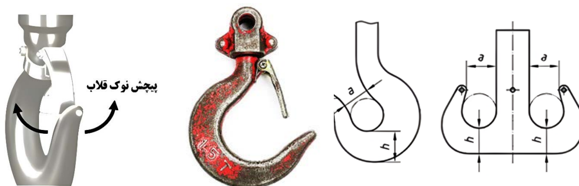
شکل ۱۴-۱۰- سمت راست: تصویر نمادین از قلاب - تصویر وسط: بازشدگی دهانه قلاب- سمت چپ: تصویر پیچش دهانه قلاب
