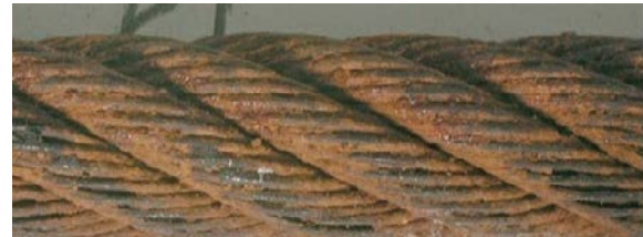
سطح حفره دار شده و سیم‌ها کاملا شل شده اند، بین سیم‌ها فاصله افتاده است - سریعا از رده خارج شود
