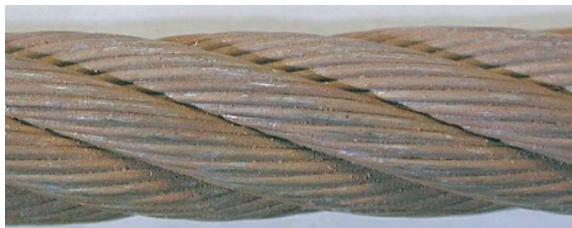
الف- شروع خوردگی سطح، که قابل تمیز کردن است، سطحی و ظاهری - شدت از ۰٪ تا مرحله از رده خارج شدن
