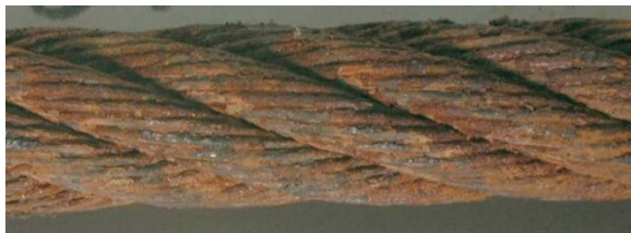
پ- سطح سیم تحت تاثیر اکسیداسیون بسیار زیاد قرار گرفته - شدت ۶۰٪ تا مرحله خارج از رده شدن
