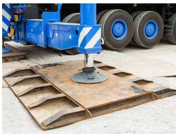
شکل ۱۶- ۱۱- استفاده از صفحه فلزی بزرگ زیر کفشک جک در زمین‌های نرم
