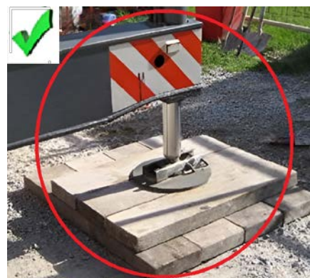
شکل ۱۶- ۱۲- قراردادن تراورس زیر بازوی جک (کاربرد اشتباه) به جای زیر کفشک جک (کاربرد صحیح)
