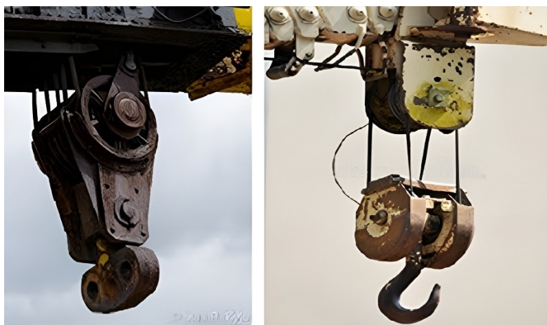
شکل ۱۵-۲۰- خوردگی اجزای مختلف بلوک بار
