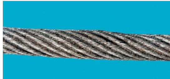
س- افزایش موضعی در قطر سیم بکسل ناشی از پیچ خوردگی هسته ۱
