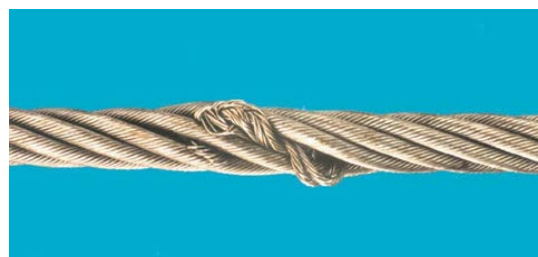
د- برآمدگی هسته (سیم‌بکسل تک لایه) ۳
