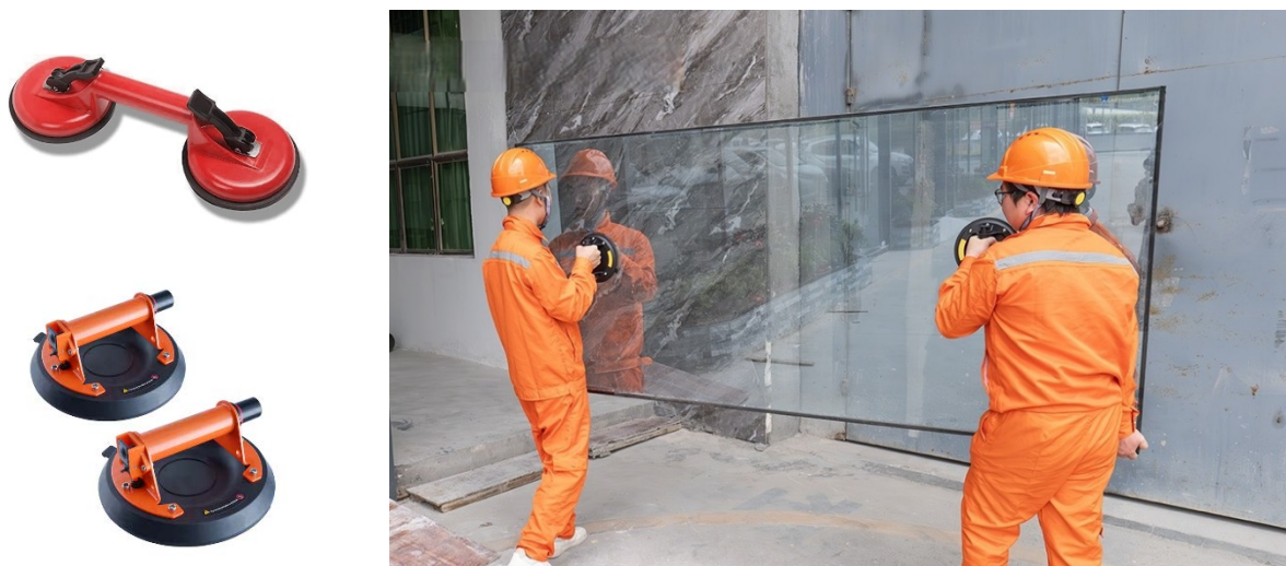
شکل ۳۱-۱- استفاده از دستگیره (مکنده‌های فنجان‌ی) به‌عنوان ابزار کمکی حمل دستی پانل‌ها (شیشه، تخته سیمانی، سنگ پلاک و ...)
