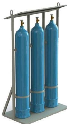
شکل ۲۳-۱- نحوه نگهداری و جابه‌جایی صحیح سیلندرها در کارگاه (۱)
