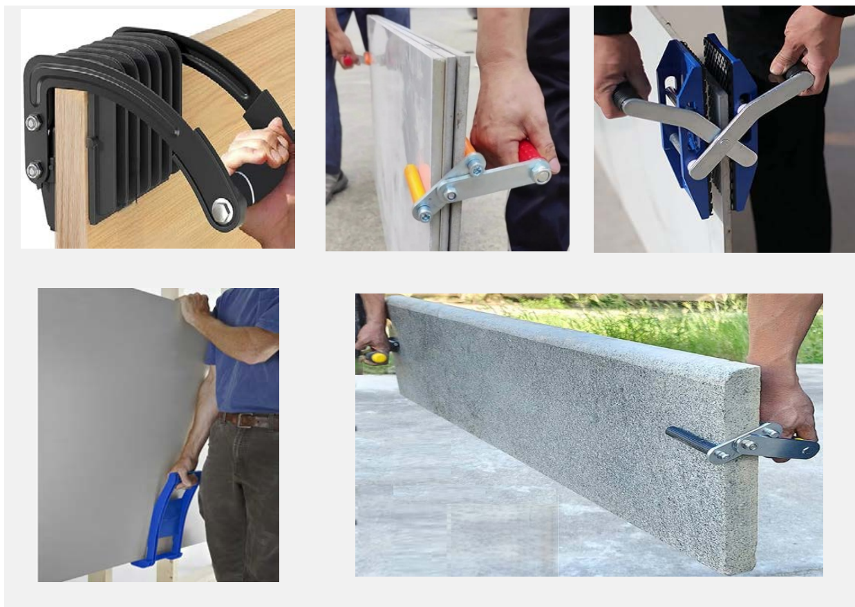
شکل ۲۸-۱- نمونه‌های انواع گیره و ابزارهای کمکی (دسته ارگونومیک) برای حمل دستی آسان‌تر و ایمن‌تر پانل‌ها، صفحات و ورق‌ها
