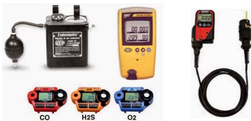
شکل ۳۴-۲- ابزارها و تجهیزات مختلف اندازه‌گیری گازهای خطرناک (گازسنجی) در فضای بسته
