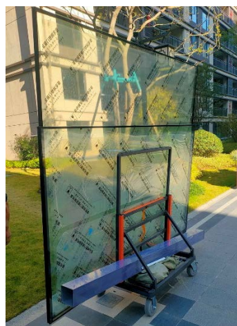
شکل ۳۱-۳- گاری (ترولی) چرخ‌دار حمل شیشه و پنل‌های بزرگ (از قبیل صفحات تخته سیمانی، سنگ پلاک)
